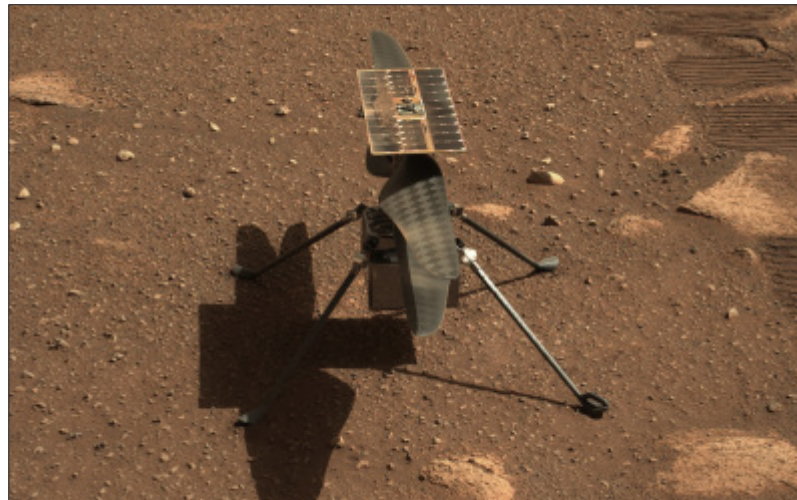
Zwei übereinander angebrachte Rotoren sollen die Drohne trotz der äußerst geringen Dichte der Mars-Atmosphäre abheben lassen – eine enorme Herausforderung für das Team um Lia Altenbuchner.
